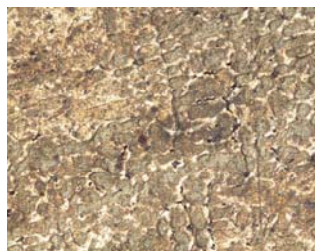
Slika 5. Uzorak 1 – 1: Izgled dendrita u centralnoj zoni, x50
