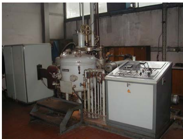
Slika 1. Vakuumska indukcione peć (VIP) 20 kg (proizvođač Leybold Heraeus – Njemačka, tip IS 2/III)
