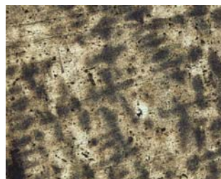
Slika 14. Uzorak 3 – 2: Izgled dendrita u centralnoj zoni, x50
